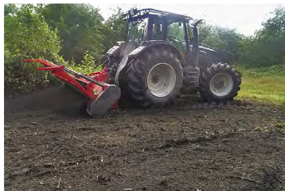
Der Einsatz eines Forstmulchers bereitet den Boden für die ökologische Aufwertung der Trasse
